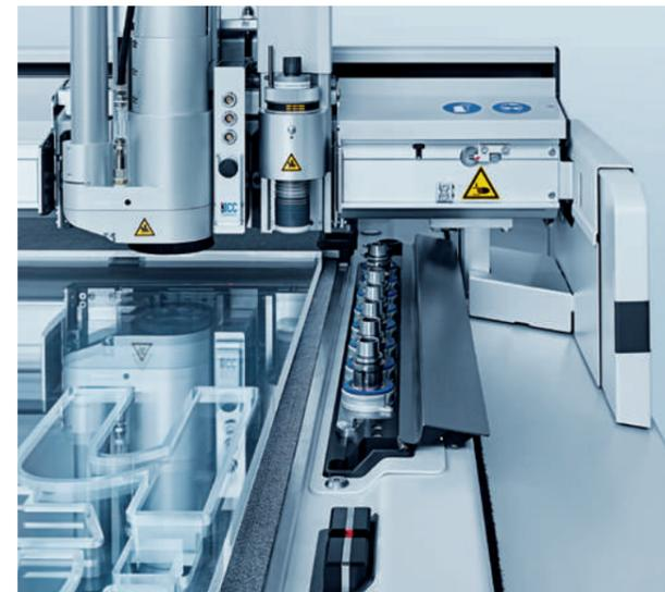
Sistema eficiente para la automatización completa del cambio de fresa, desde la elección de la fresa correcta hasta la sujeción, inicialización y limpieza de la fresa.
